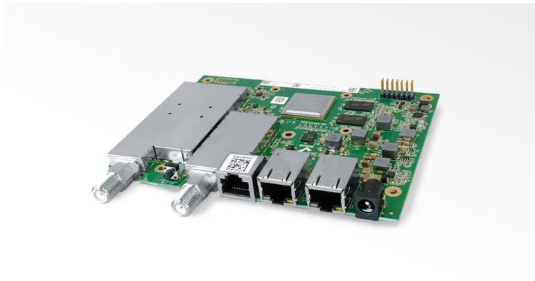
板卡式 iQ 200 调制解调器是 ST Engineering iDirect 公司 DVB-S2/S2X 调制解调器系列的一部分，具有软件定义的体系结构，可实现最大的灵活性和扩展性。
